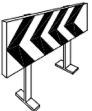
BALIZAMIENTO DE GALIBO DE OBRA
